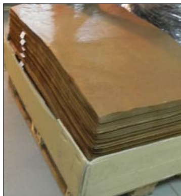
Пример вощёной промежуточной прокладки (не разрешается)
