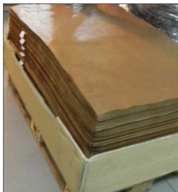
Exemple d'un intercalaire ciré (non admissible)
