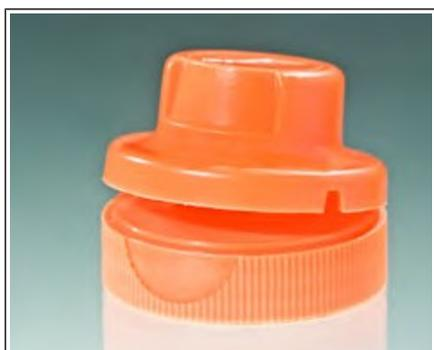
Рис. 34: Нет фиксации пробки
