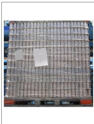
Рис. 10: Штабель новых доз со слегка согнутыми промежуточными прокладками в зоне кромок
