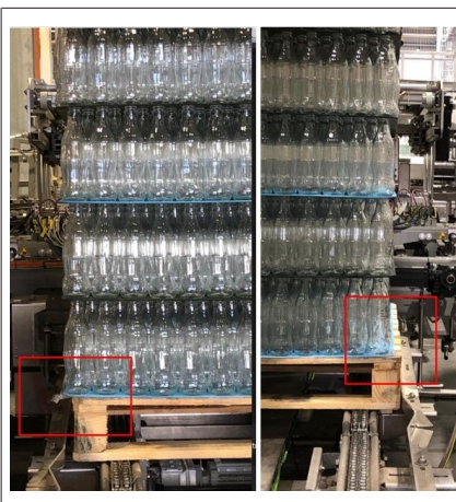
Рис. 18: Штабель новых сосудов с сильно сдвинутым влево рядом
