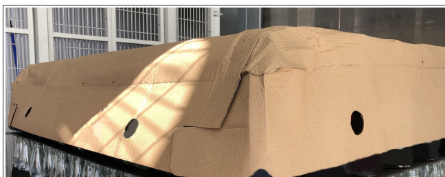
Рис. 20: Деформированная верхняя крышка
