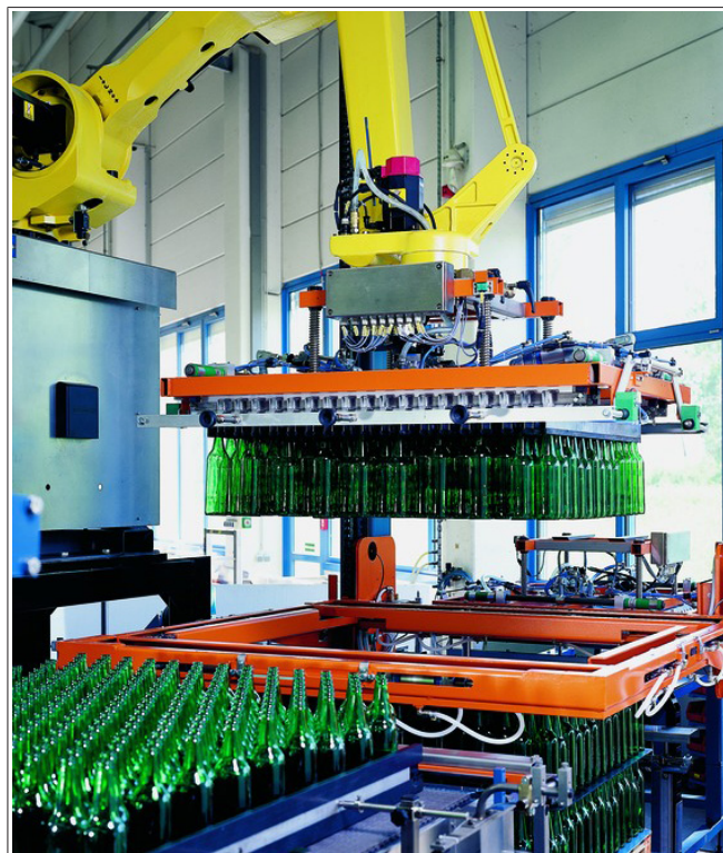
Рис. 4: Полностью автоматический подъём захватом планками или шлангами
