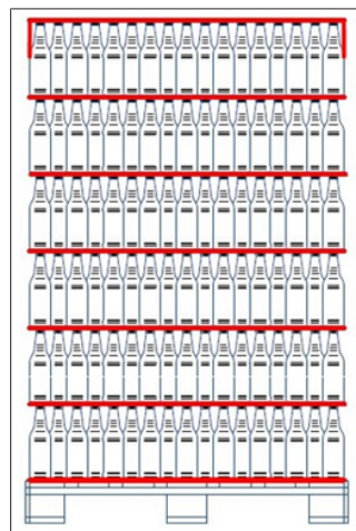
Рис. 52: Система промежуточных прокладок без, или только с одной верхней крышкой в качестве верхнего слоя (ряда); функционально хорошо для сдвигателя
