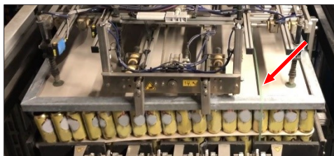
Рис. 57: Помеха при подъёме верхней рамки. Причина: Забытая, не удалённая лента обвязки по окружности на штабеле новых сосудов
