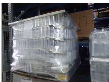
Рис. 82: Сильно повреждённый поддон для новых доз
