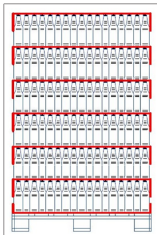
Рис. 51: Система верхней крышки с нижним лотком в качестве нижней прокладки; функционально хорошо для съёмника
