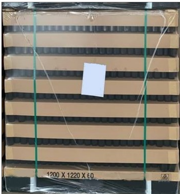
Рис. 56: Зелёные ленты обвязки с верхними рамками на штабеле новой стеклотары
