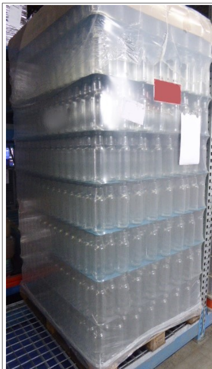
Рис. 6: Оптимально выравненный штабель новых сосудов с пластиковыми промежуточными прокладками
