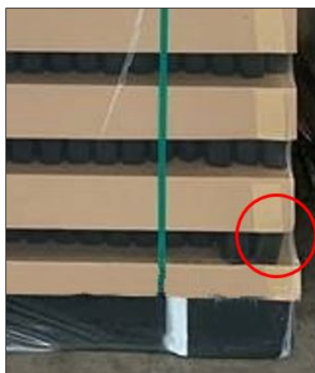
Рис. 53: Штабель с новой стеклотарой со слишком большой верхней крышкой и соскользнувшими бутылками
