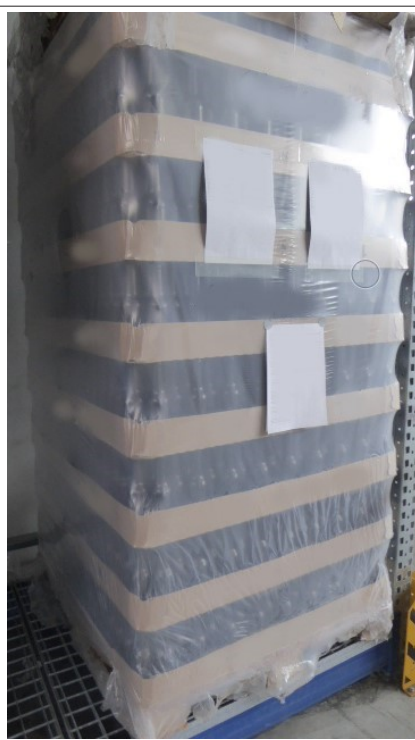
Рис. 7: Оптимально выравненный штабель новых сосудов с нижними лотками
