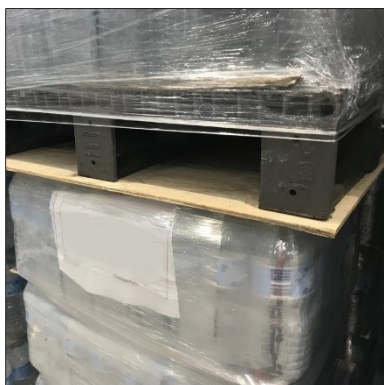
Рис. 55: Штабель новых сосудов с пластиной для распределения нагрузки
