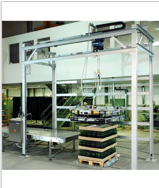
Рис. 3: Полуавтоматический порталный съёмник с ручным управлением захвата планками
