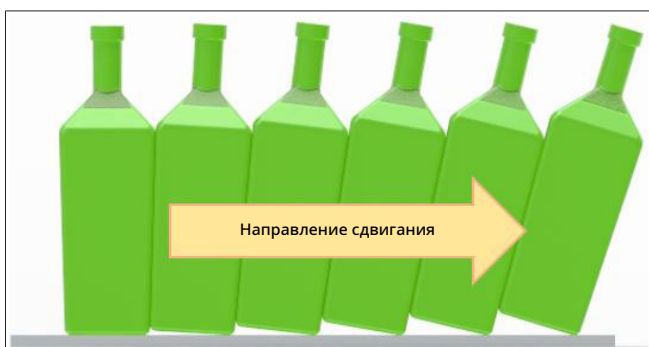
Рис. 73: Проблемы с опрокидыванием при сдвигании конических сосудов
