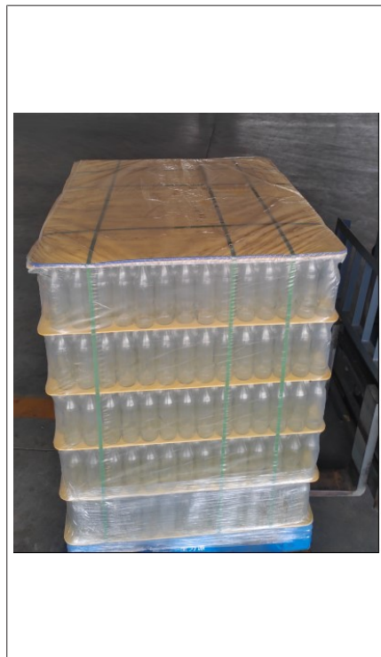
Рис. 8: Оптимально выравненный штабель новых сосудов с лентами обвязки
