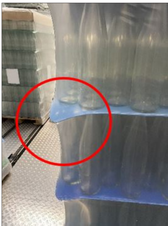
Рис. 41: Промежуточная прокладка, наклонённая вниз
