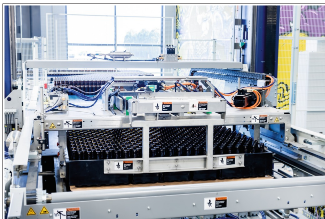
Рис. 1: Полностью автоматический сдвигатель с сосудами в круглой формации упаковке
