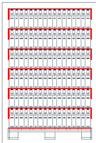
Рис. 50: Система верхней крышки с плоской прокладкой внизу; функционально хорошо для сдвигателя
