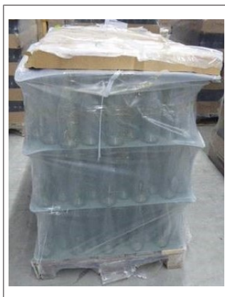
Рис. 11: Штабель новых сосудов со слегка сдвинутыми верхними крышками (требуется ручное снятие) и согнутыми промежуточными прокладками
