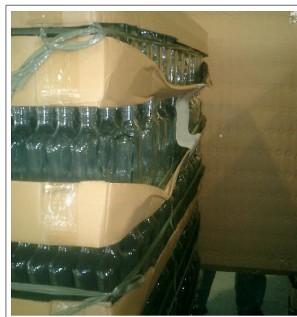
Рис. 19: Штабель новых сосудов с сильно деформированными нижними лотками и сдвинутыми сосудами
