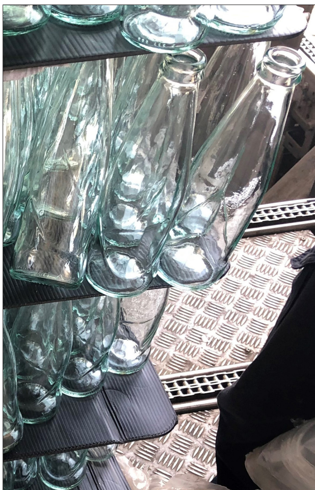
Рис. 44: Упавшие угловые сосуды после снятия плёнки
