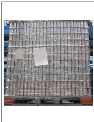
Fig. 10: Pile de boîtes neuves avec intercalaires légèrement pliés sur le bord
