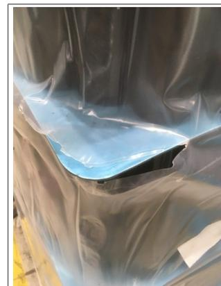
Fig. 12: Pile de récipients neufs avec film d'emballage déchiré
