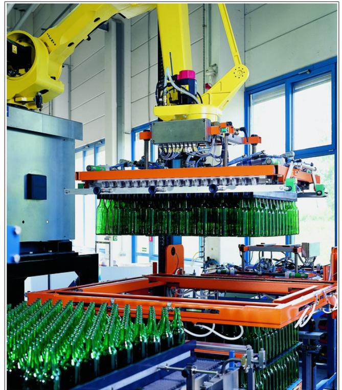
Fig. 4: Dépalettisation entièrement automatique avec préhenseur flexible ou préhenseur à listeaux
