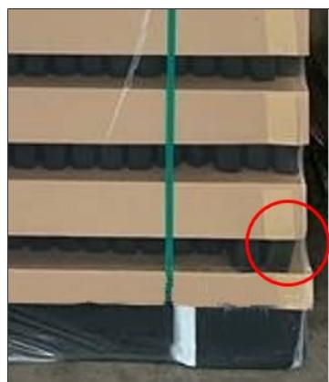
Fig. 53: Pile de verre neuf avec coiffe trop grande et bouteilles décalées
