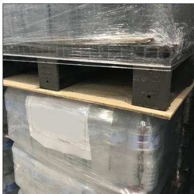
Fig. 55: Pile de récipients neufs avec plaque de répartition de charge
