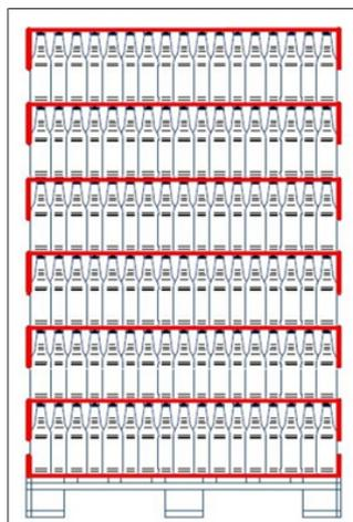
Fig. 51: Système de coiffe avec une barquette comme couche de fond ; bonne fonctionnalité pour le dépalettiseur par préhension
