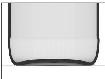
Fig. 74: Fond de bouteille de forme droite
