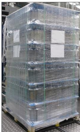
Fig. 40: Pile de verre neuf emballée dans du film étirable
