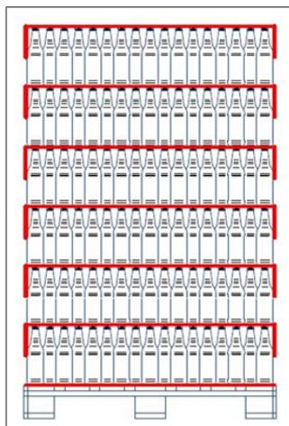
Fig. 50: Système de coiffe avec couche de fond plate ; bonne fonctionnalité pour le dépalettiseur par poussée
