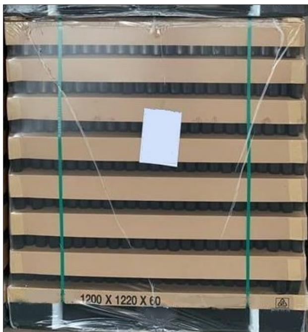
Fig. 56: Bandes de cerclage vertes avec cadre protecteur sur une pile de verre neuf
