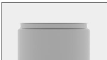
Fig. 81: Vue latérale d'une boîte avec molette de sertissage pas encore pliée
