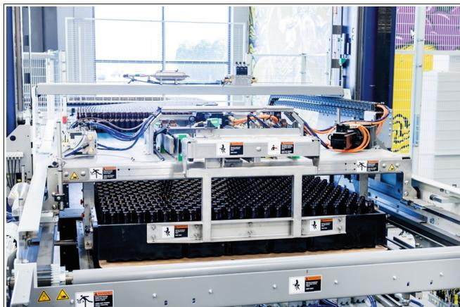
Fig. 1: Dépalettiseur par poussée entièrement automatique avec récipients en formation par emballage imbriqué
