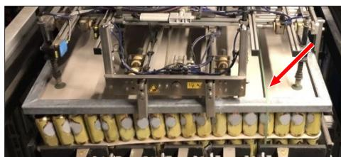
Fig. 57: Incident lors de la saisie du cadre protecteur. Raison : bande de cerclage oubliée, laissée sur le tour de la pile de récipients neufs
