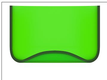
Fig. 76: Vue en coupe d'une bouteille avec un creux léger
