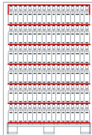
Fig. 52: Système d'intercalaires avec aucune ou une coiffe comme couche supérieure ; bonne fonctionnalité pour le dépalettiseur par poussée
