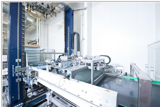
Fig. 2: Dépalettiseur par poussée entièrement automatique pendant la poussée
