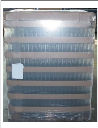
Abb. 9: Neubehälterstapel mit eingedrückt Stülpdeckel-Ecken
