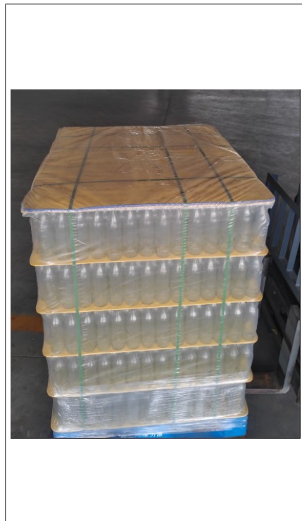
Abb. 8: Optimal ausgerichteter Neubehälterstapel mit Umreifungsbändern
