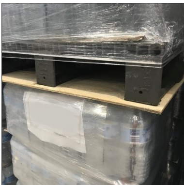
Abb. 55: Neubehälterstapel mit Lastverteilungsplatte
