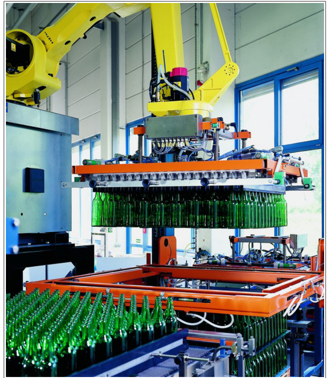
Abb. 4: Vollautomatisches Abheben mit Leisten- oder Schlauchgreifer
