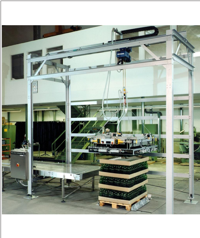
Abb. 3: Halbautomatischer Portalabheber mit manuell gesteuertem Leistengreifer
