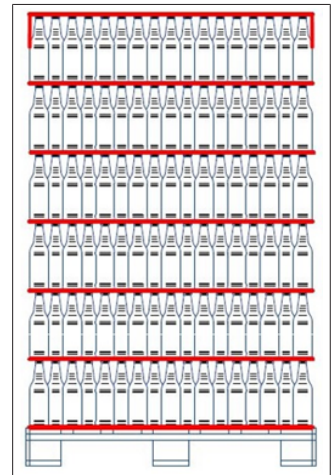
Abb. 52: System Zwischenlagen mit keinem oder nur einem Stülpdeckel als Toplage; Funktional gut für Abschieber
