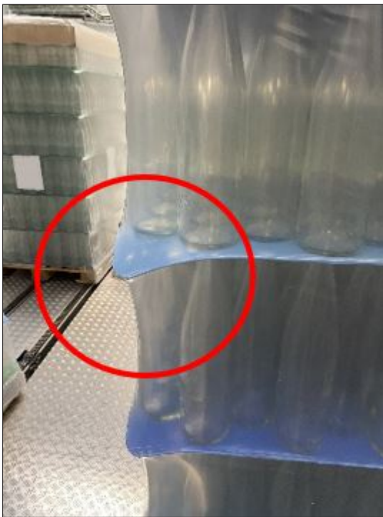
Abb. 41: Nach unten geneigte Zwischenlage
