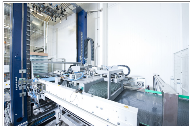
Abb. 2: Vollautomatischer Abschieber während des Abschiebevorgangs
