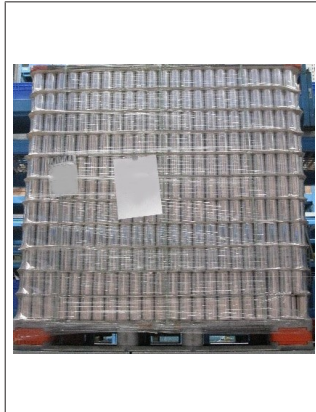
Abb. 10: Neudosenstapel mit leicht abgeknickten Zwischenlagen im Randbereich
