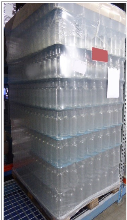
Abb. 6: Optimal ausgerichteter Neubehälterstapel mit Kunststoff-Zwischenlagen
