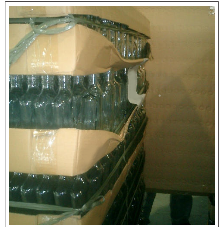
Abb. 19: Neubehälterstapel mit stark deformierten Stülpböden und verrutschten Behältern
