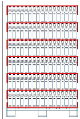
Abb. 51: System Stülpdeckel mit einem Stülpboden als Bodenlage; Funktional gut für Abheber
