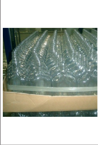
Abb. 13: Neubehälterstapel mit verrutschten Behälterreihen
