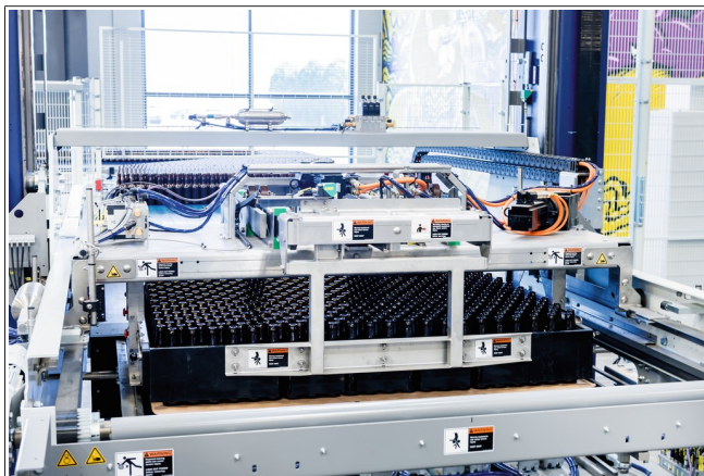
Abb. 1: Vollautomatischer Abschieber mit Behältern in Kugelpack-Formation
