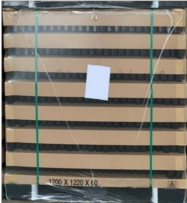
Abb. 56: Grüne Umreifungsbänder mit Deckrahmen auf einem Neuglasstapel
