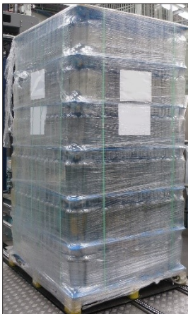
Abb. 40: In Stretchfolie verpackter Neuglasstapel
