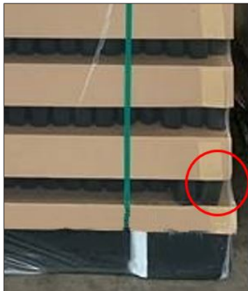
Abb. 53: Neuglasstapel mit zu großem Stülpdeckel und verrutschten Flaschen
