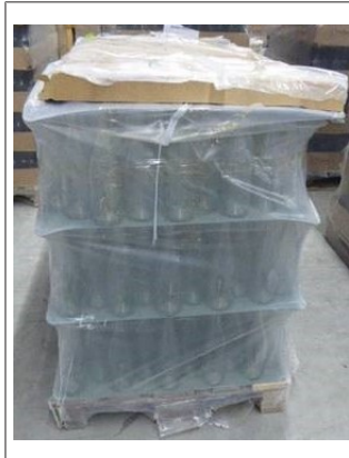
Abb. 11: Neubehälterstapel mit leicht verschobenem Stülpdeckel (manuelle Abnahme erforderlich) und abgeknickten Zwischenlagen
