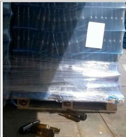
Abb. 17: Neubehälterstapel mit herausgefallenen Behältern
