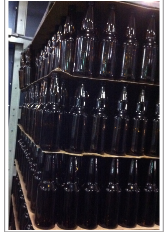
Abb. 16: Neubehälterstapel mit heruntergefallener Behälterreihe in der oberen Lage
