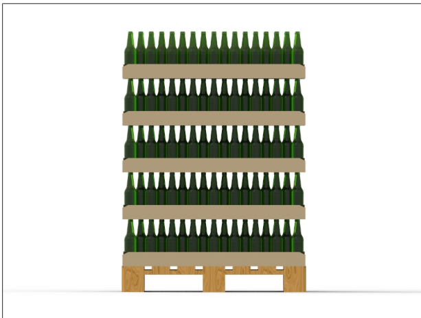
Abb. 25: Senkrechter Stapel mit hoher Stapelgenauigkeit
