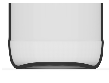
Abb. 74: Flaschenboden mit einer geraden Bodenform
