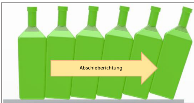
Abb. 73: Kippproblematik beim Abschieben von konischen Behältern
