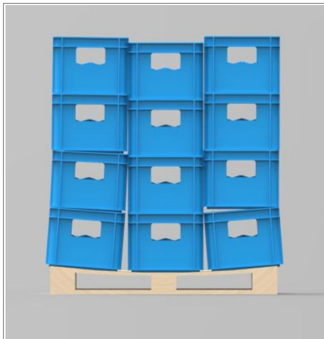
Рис. 73: Поддон вогнутый вниз: условно критический, если ящики все ещё входят в зацепление
