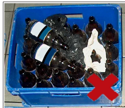
Рис. 48: Посторонний предмет и неправильно ориентированные стеклянные бутылки в ящике
