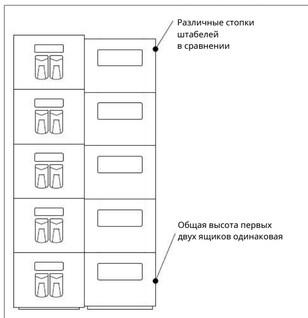
Рис. 51: Слева низкое углубление для входа в зацепление при штабелировании, справа высокое углубление для входа в зацепление при штабелировании
