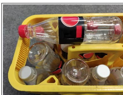
Рис. 43: Повреждённые и неправильно ориентированные PET-сосуды
