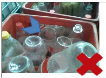
Рис. 68: Ящик для напитков с неправильно ориентированными сосудами
