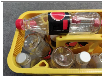
Fig. 43: Bottiglie in PET danneggiate o inserite al contrario
