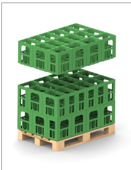
Fig. 87: Pile di confezioni intrecciate a 180° su pallet
