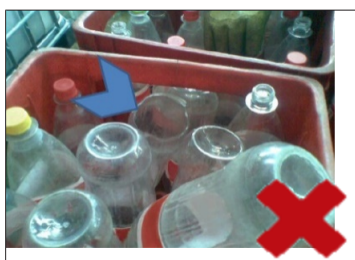
Fig. 68: Cassa per bevande con recipienti inseriti al contrario
