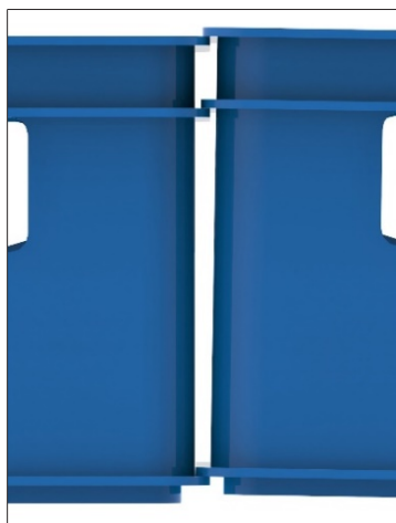
Fig. 64: Nervature di rinforzo di due casse inserite l'una nell'altra
