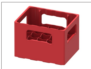
Fig. 30: Geometria esterna ottimale di una cassa per bevande
