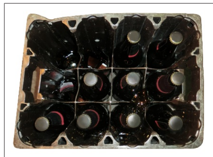
Fig. 45: Pareti della cassa ammaccate
