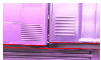
Fig. 52: A sinistra cavità di inserimento bassa, a destra cavità di inserimento alta
