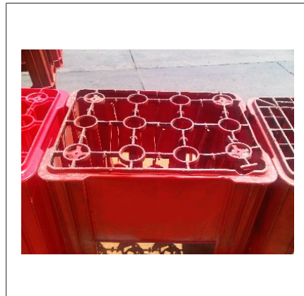
Fig. 40: Fondo della cassa con piccole rotture
