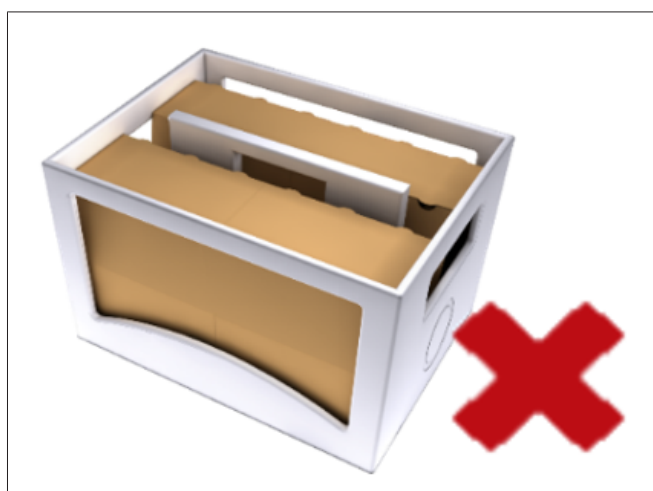
Fig. 61: Disposizione svantaggiosa di multipack nella cassa
