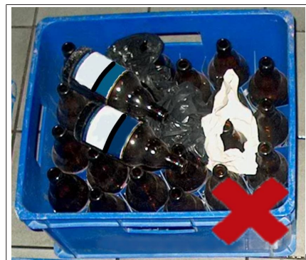
Fig. 48: Corpi estranei e bottiglie di vetro inserite al contrario nella cassa
