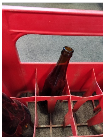
Fig. 59: Bottiglia in vetro che non poggia completamente sul fondo della cassa
