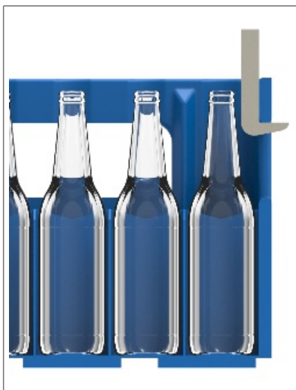
Fig. 26: Inserimento del gancio in cassa per bevande (vista in sezione)
