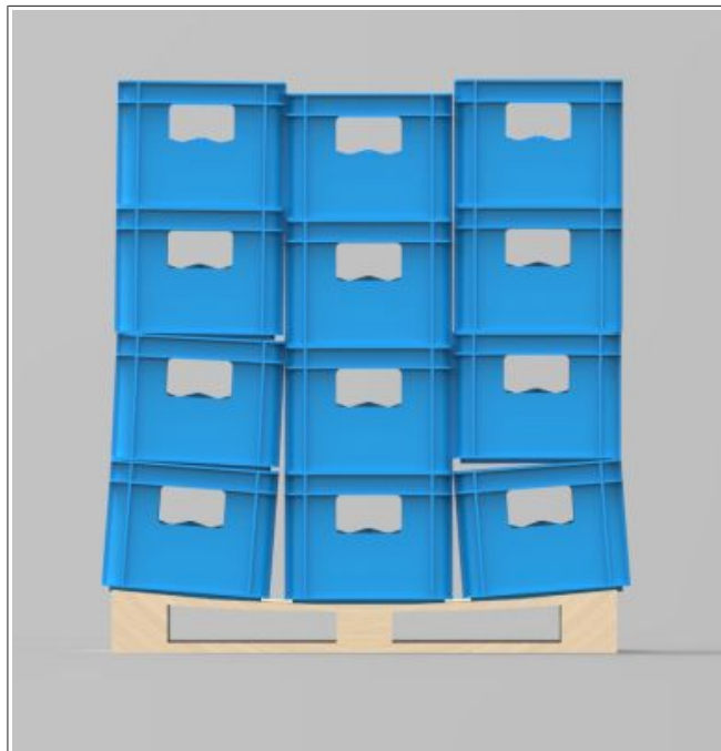
Fig. 73: Pallet incurvato verso il basso: non particolarmente svantaggioso fintanto che le casse si inseriscono ancora le une nelle altre
