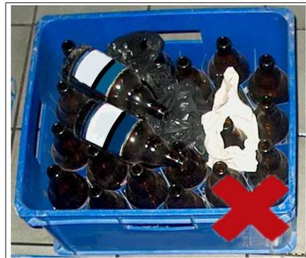
Fig. 48: Corps étranger et bouteilles en verre mal orientées dans la caisse
