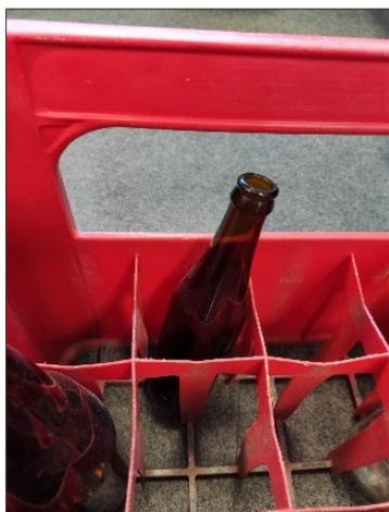
Fig. 59: Bouteille en verre ne reposant pas sur toute la surface sur le fond de caisse
