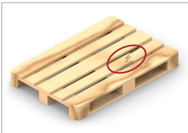
Fig. 77: dès qu'une planche est cassée dans le sens transversal ou en biais.
