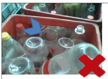
Fig. 68: Caisse de boissons avec récipients mal orientés
