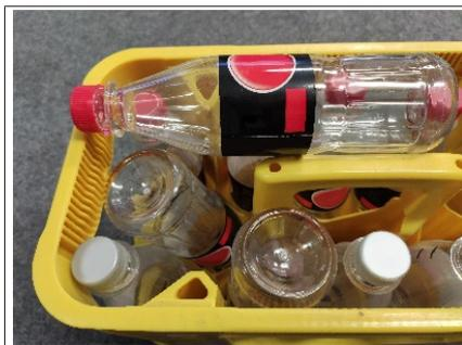
Fig. 43: Bouteilles PET mal orientées et endommagées
