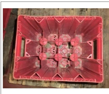
Fig. 42: Paroi de caisse légèrement enfoncée
