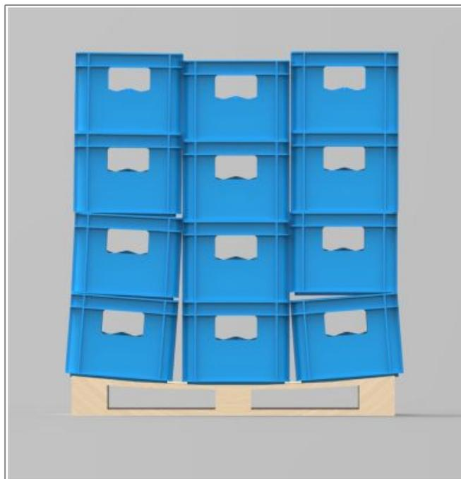
Fig. 73: Palette affaissée : modérément critique tant qu'il y a encore un engagement des caisses
