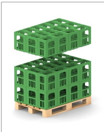
Fig. 86: Empilage en colonnes sur la palette
