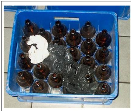
Fig. 46: Corps étrangers dans la caisse
