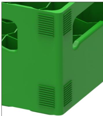
Des « renforcements » horizontaux au niveau des angles de la caisse de boissons permettent de créer un maintien à engagement positif de plusieurs caisses entre elles. Et grâce à la réduction des forces de blocage nécessaires, les charges et les déformations élastiques subies par les caisses de boissons baissent.
