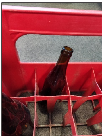
Fig. 59: La botella de vidrio no se apoya perfectamente sobre el fondo de la caja
