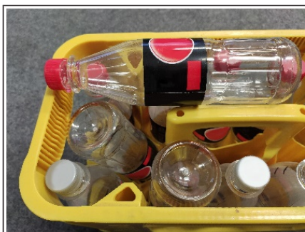
Fig. 43: Botellas de PET dañadas y mal orientadas
