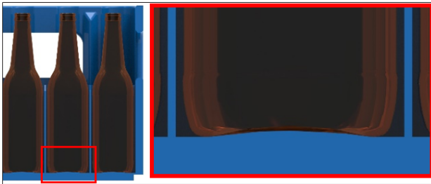
Fig. 31: Abombamiento del fondo de los separadores y de las botellas
