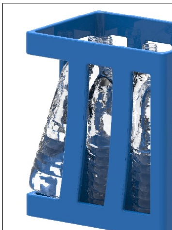
Abb. 56: Getränkekasten mit zu großem Eckfenster
