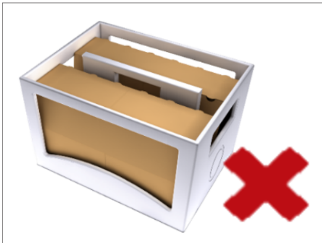
Abb. 61: Ungünstige Anordnung von Multipacks im Kasten
