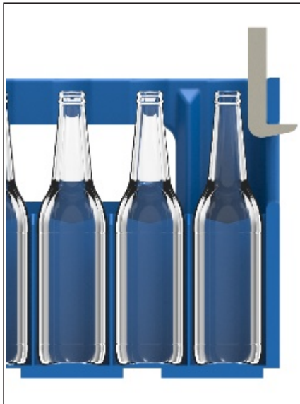
Abb. 26: Hakeneingriff im Getränke- kasten (Schnitt-Ansicht)
