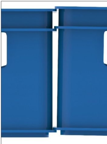
Abb. 64: Ineinandergeschobene Versteifungsrippen von zwei Kästen
