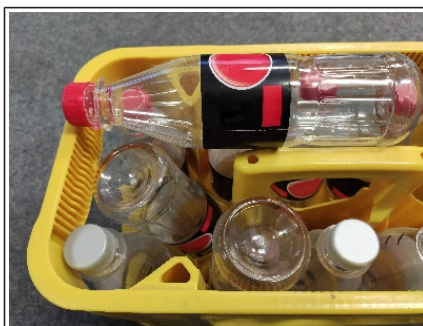
Abb. 43: Beschädigte und falsch orientierte PET-Flaschen
