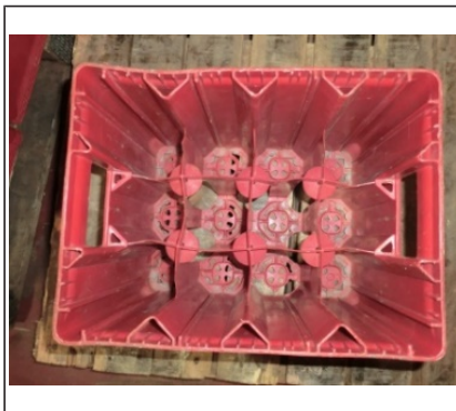
Abb. 42: Leicht eingedrückte Kastenwandung
