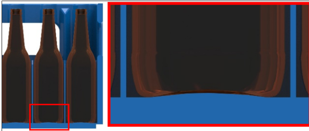
Abb. 31: Wölbung des Gefache- und des Flaschenbodens
