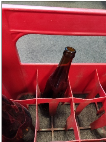
Abb. 59: Nicht vollflächig am Kastenboden stehende Glasflasche
