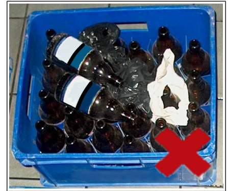
Abb. 48: Fremdkörper und falsch orientierte Glasflaschen im Kasten
