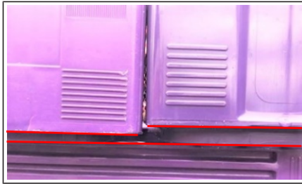
Abb. 52: Links niedrige Einrastvertiefung Rechts hohe Einrastvertiefung
