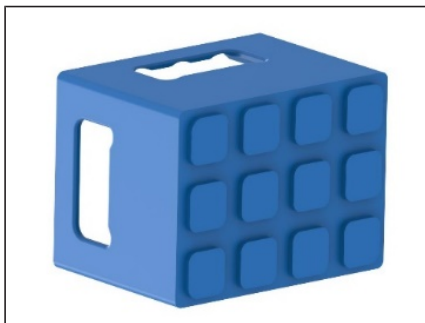
Abb. 89: Nesterverteilung für Verbundstapelung
