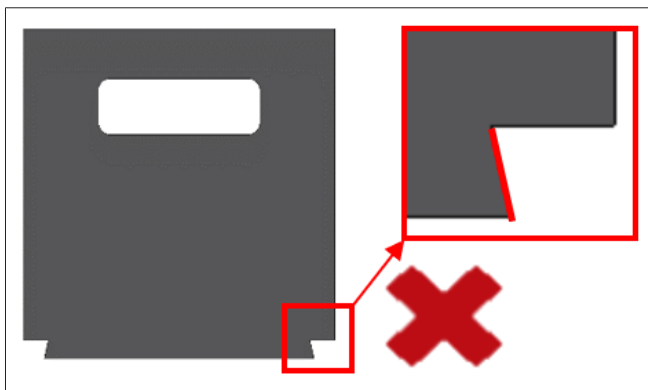
Abb. 53: Älteres Kastenmodell mit ungünstiger Einrastgeometrie
