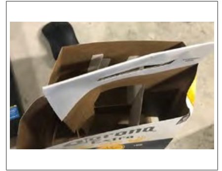
图 90: 箱坯造成的变形
