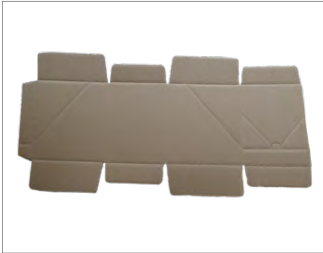
图 55: 全裹包式纸箱展开的扁平箱坯
