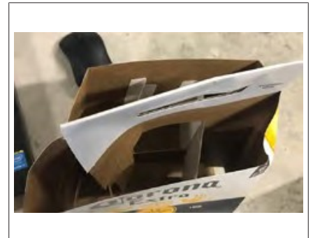
Abb. 90: Deformation durch Zuschnitt
