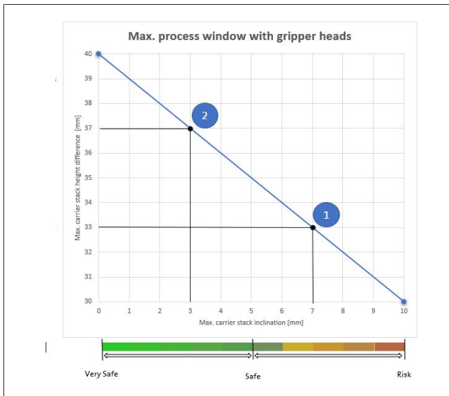
Abb. 139: Bereiche des zulässigen Stapelhöhenunterschieds in Abhängigkeit zur Schiefelage
