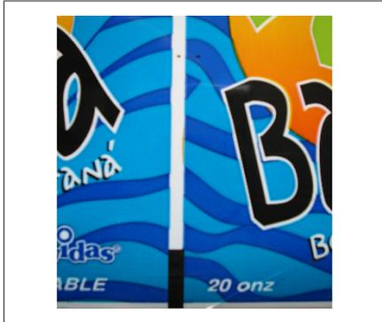
图 91: 在切割标记前后的扫描区域中有一种以上的颜色，并且颜色对比度不足
