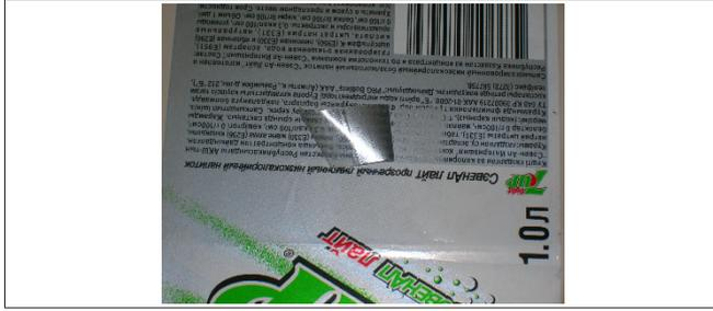
图 67: 透明胶带测试
