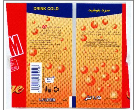
图 93: 在切割标记前后的扫描区域中有一种以上的颜色，并且未考虑扫描区域的最小尺寸
