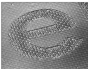
Fig. 6: Ingrandimento di una forma tipografica per serigrafia
