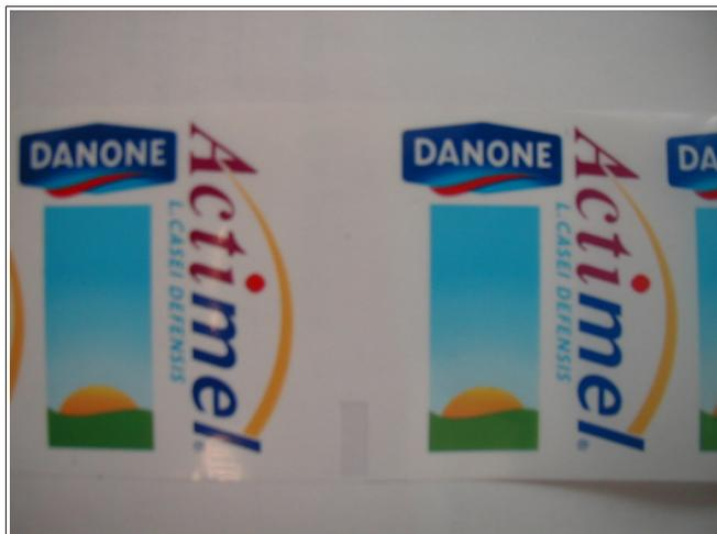
Fig. 89: Esempio di un'etichetta trasparente con una tacca di taglio trasparente non stampata
