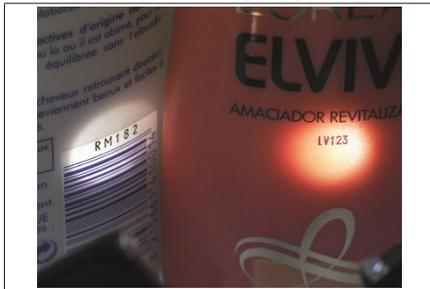
Fig. 14: Codifica con goffratura a caldo
