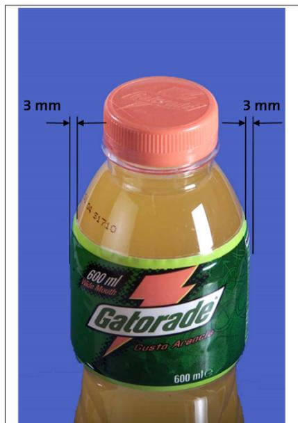
Fig. 70: Esempi di applicazioni termoretraibili con colla a caldo
