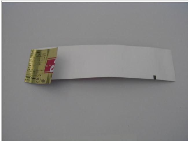
Fig. 86: Esempio di una tacca di taglio sulla parte posteriore dell'etichetta
