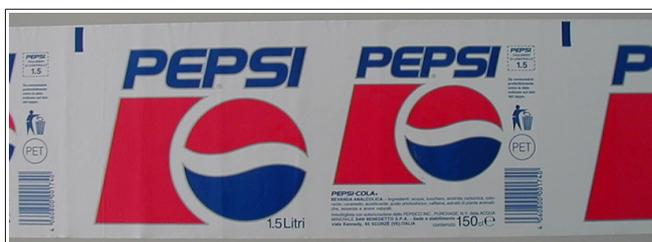
Fig. 84: Esempio di una tacca di taglio sul bordo superiore dell'etichetta
