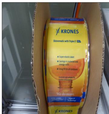
Fig. 112: Décalage de couche (tolérance d'enroulement)
