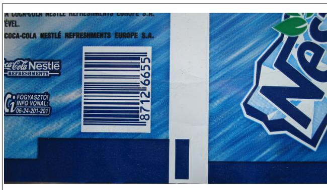
Fig. 94: Plusieurs couleurs dans la zone de détection avant et après le repère de coupe
