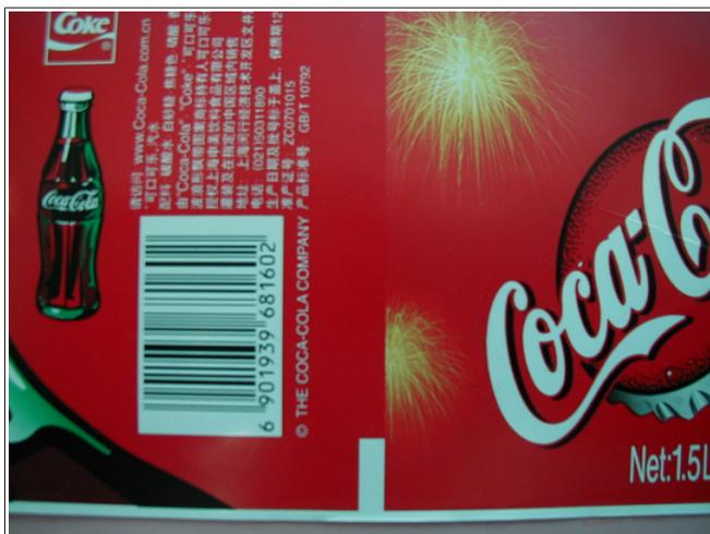
Fig. 85: Exemple de repère de coupe sur le bord inférieur de l'étiquette
