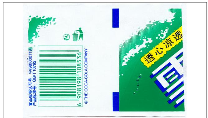
Fig. 95: Plusieurs couleurs dans la zone de détection avant et après le repère de coupe
