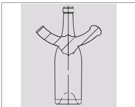
Fig. 29: Colletette champenoise : pour les bouteilles de champagne ; superposée au niveau du col/de la colletette
