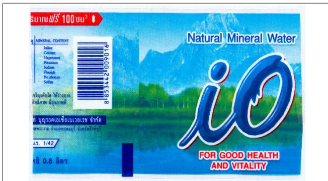
Fig. 90: Repère de coupe bleu sur fond bleu, contraste de couleur pas suffisant
