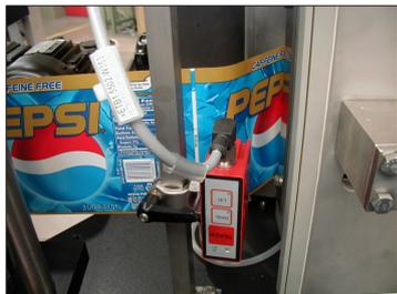
Fig. 73: Détection sensorielle d'un repère de coupe
