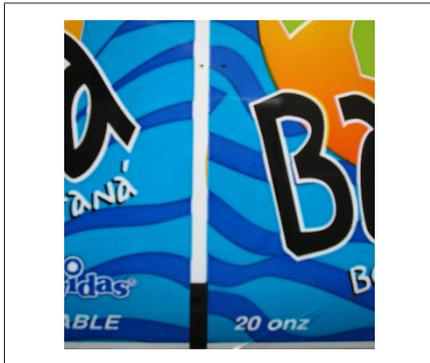
Fig. 91: Plusieurs couleurs dans la zone de détection avant et après le repère de coupe et contraste de couleur pas suffisant
