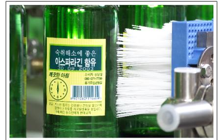
Fig. 16: Datage au jet d'encre
