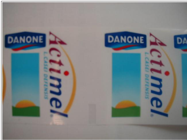
Fig. 89: Exemple d'étiquette transparente avec repère de coupe transparent, non imprimé
