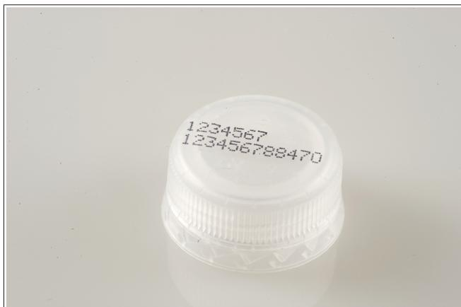
Fig. 8: Datação a jato de tinta na tampa
