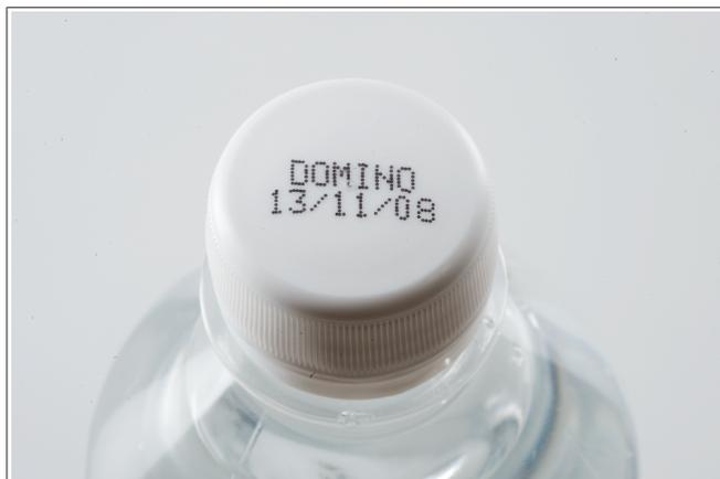
Fig. 9: Datação a jato de tinta na tampa
