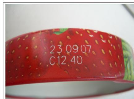
Fig. 12: Datação a laser em tampa metálica
